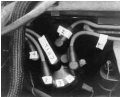
Figure. Fig. 9: Numéroté les fils et le capuchon avec du ruban adhésif à des fins de référence
