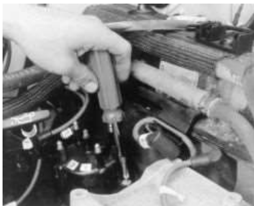
Figure. Fig. 11 : Détacher les vis de retenue du bouchon du distributeur
