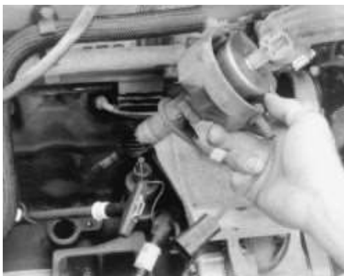
Figure. Fig. 15 : Soulevez le distributeur vers le haut et hors du moteur
