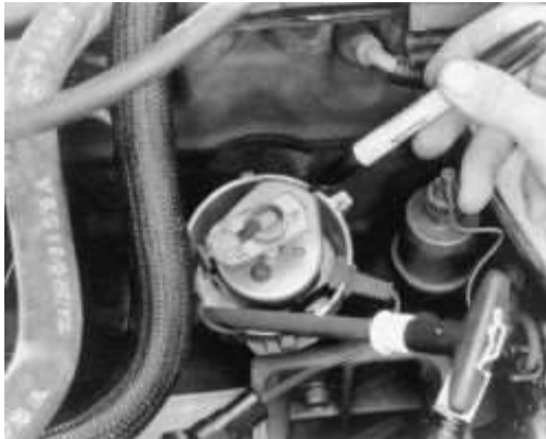
Figure. Fig. 13 : Scribe une marque sur le boîtier du distributeur en ligne avec la pointe du rotor
