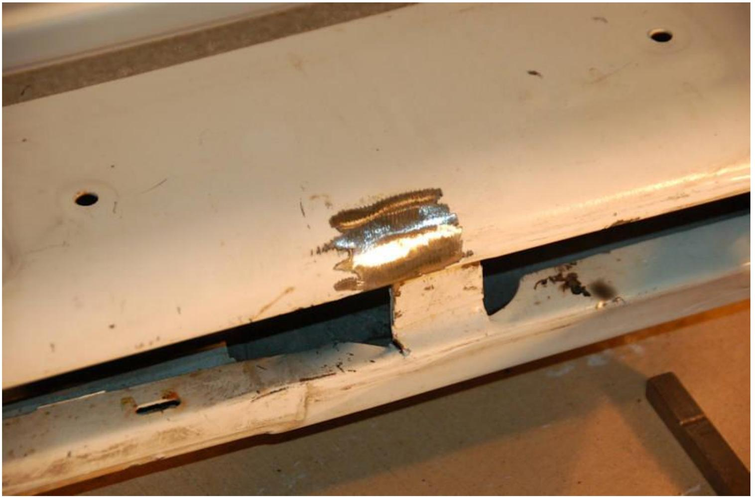
La chose gentille au sujet de cette réparation, et où il obtient soudé, est que vous pouvez faire cette réparation sur les portes non fissurés, et vous n'aurez pas besoin de repeindre tout le visible les surfaces des portes - les soudures sont à l'intérieur de la porte, et couvert par le coupe-froid, donc une petite retouche de peinture à l'intérieur va prévenir la rouille et finir le.
