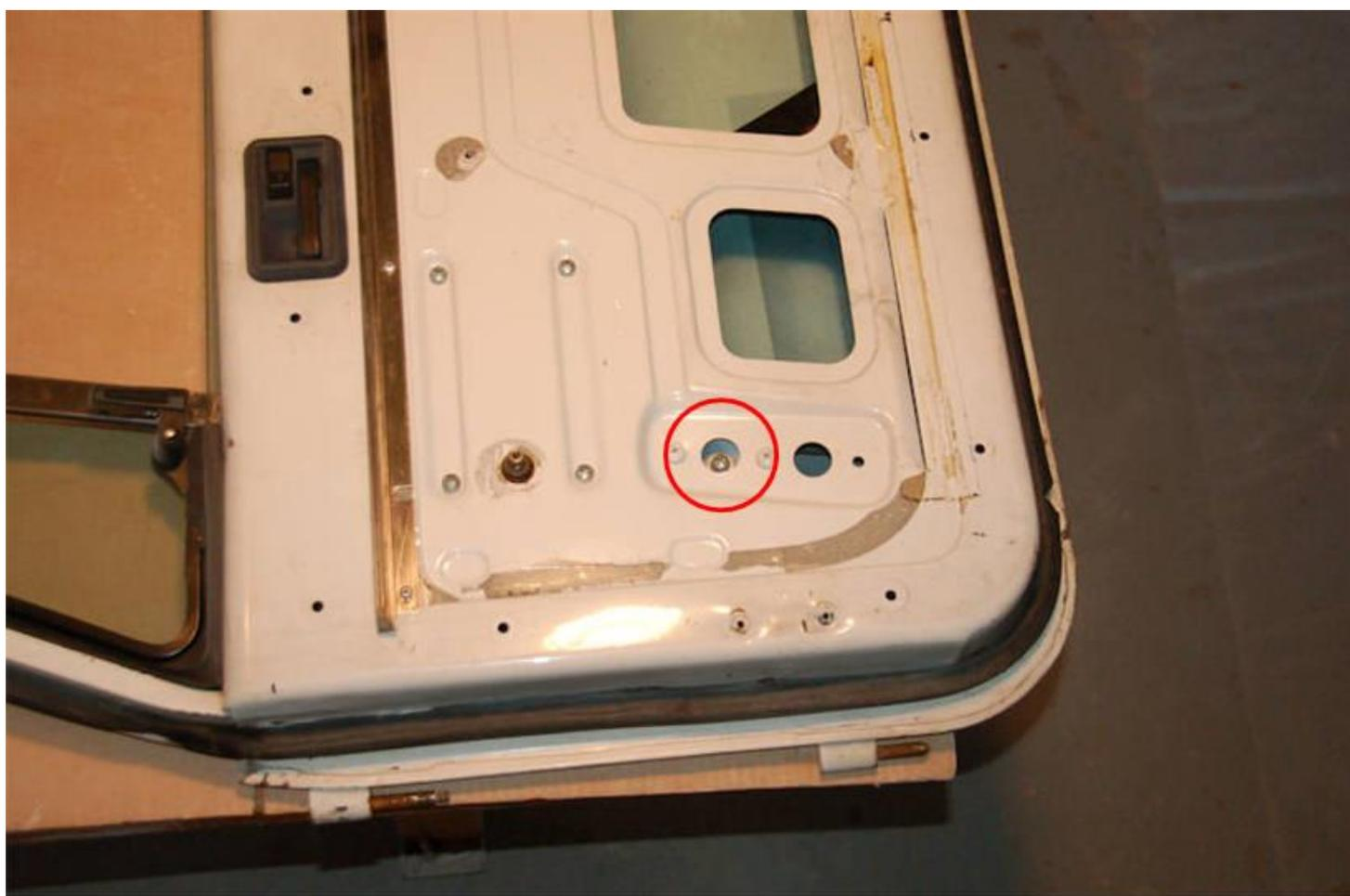
Maintenant tirer quelques pouces du chenal de coupe-froid de fenêtre principale à partir du canal comme indiqué ci-dessous. Ce bourrelet est une presse rentre dans le canal, c'est assez facile à retirer.
