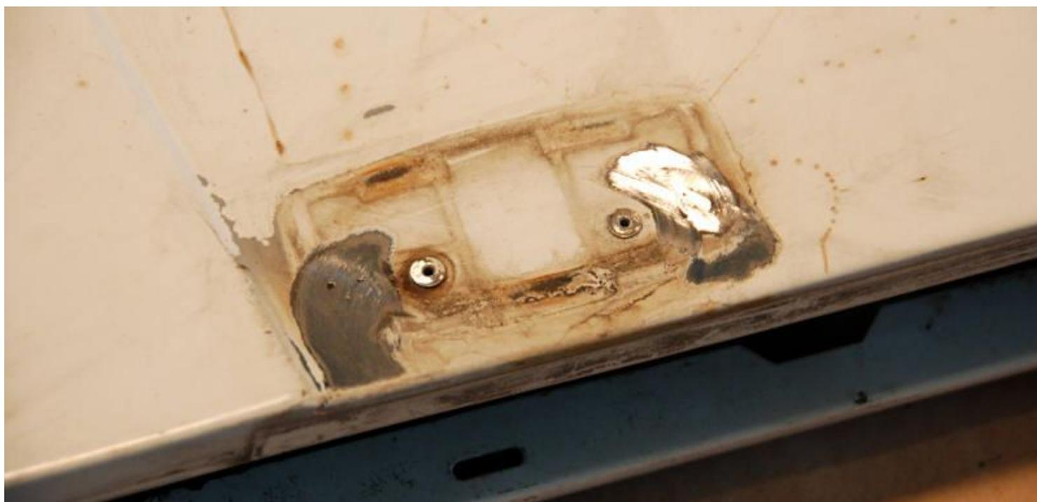
Et voici le fini de la soudure. Vous pouvez voir une petite dépression le long du bord avant de la porte (bord avant sur cette photo, en fait la partie supérieure de la peau de porte) - il s'agit d'une petite dent cause par un choc pour le miroir à un moment donné dans le passé de la porte. C'est un petit creux, et puisqu'il n'est pas facilement accessible de l'intérieur, je vais juste utiliser remplissage il aplanir.
