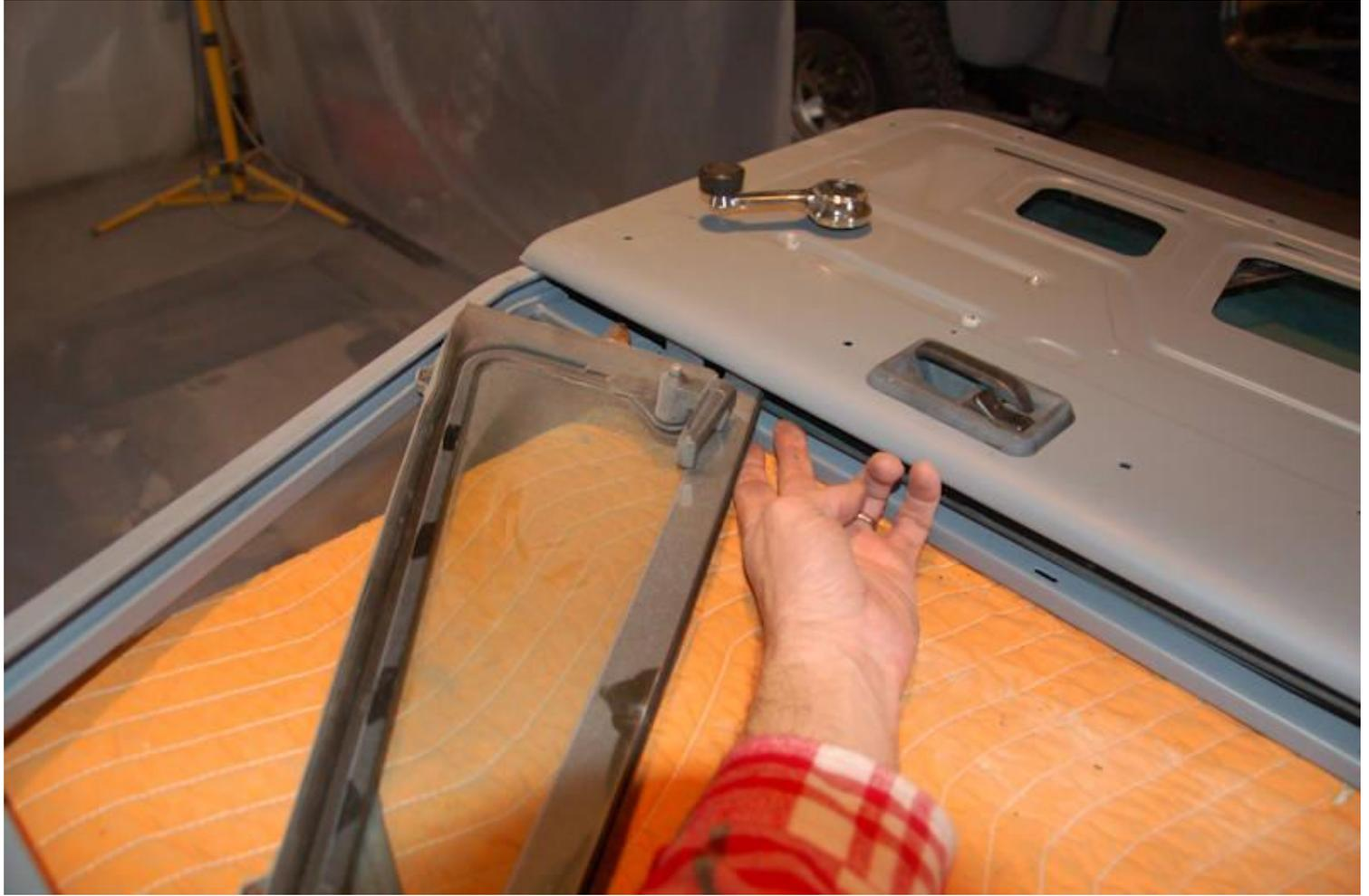
9. si vous avez vérifié que tous les mécanismes fonctionnent (poignées de dégagement de porte intérieur et extérieur, intérieur et extérieur de serrure, fenêtre manivelles de haut en bas), puis mettez la plaque de recouvrement Ober le mécanisme de verrouillage et installez l'intérieur garniture panneau et les autres pièces diverses.
