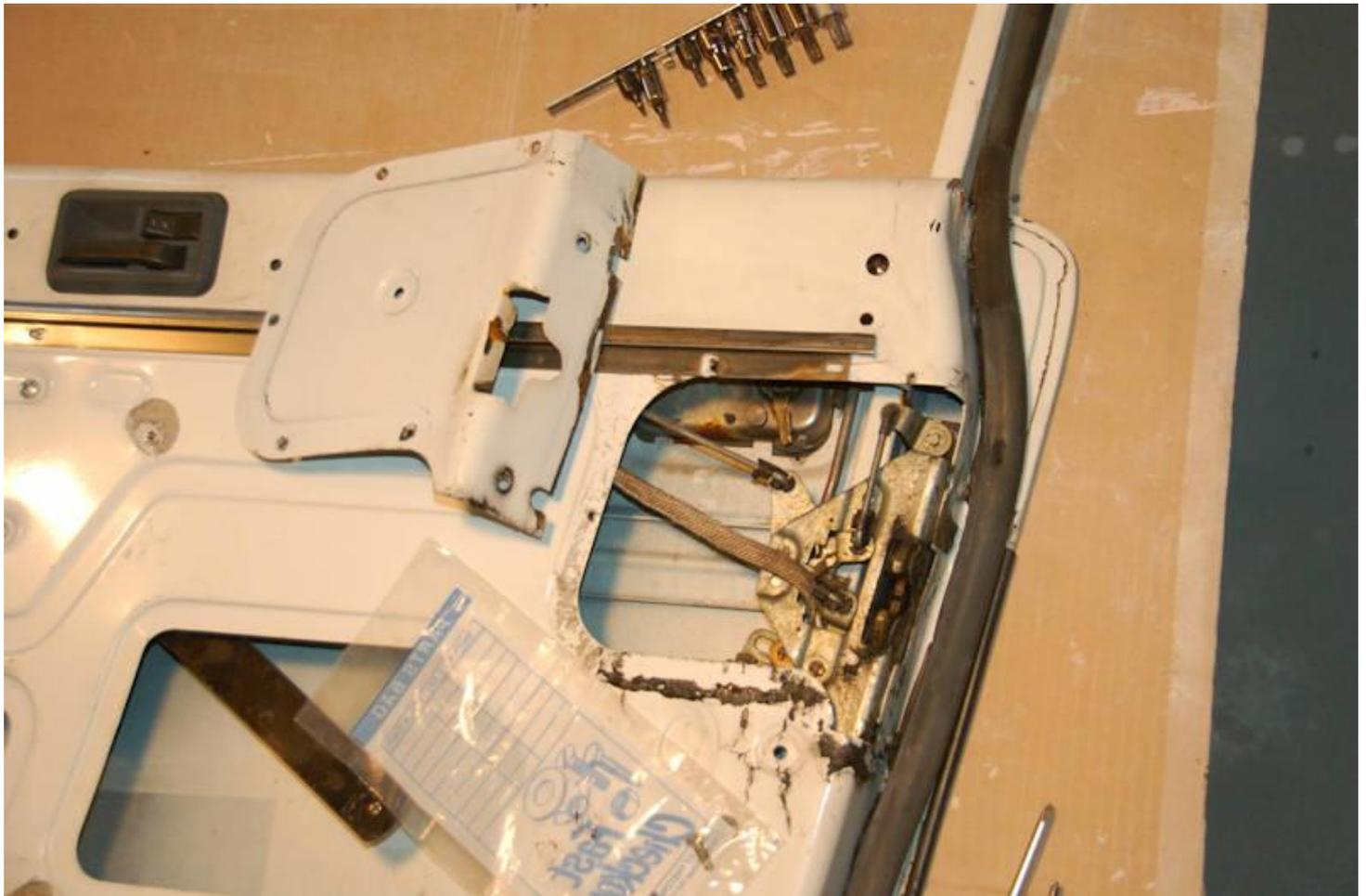
Enlever les tiges de commande en balançant les clips sur les tiges comme indiqué. Il y aura trois à enlever - un pour la poignée de porte intérieure, une pour le bouton de verrouillage de porte et l'autre depuis le cylindre de serrure de porte.
