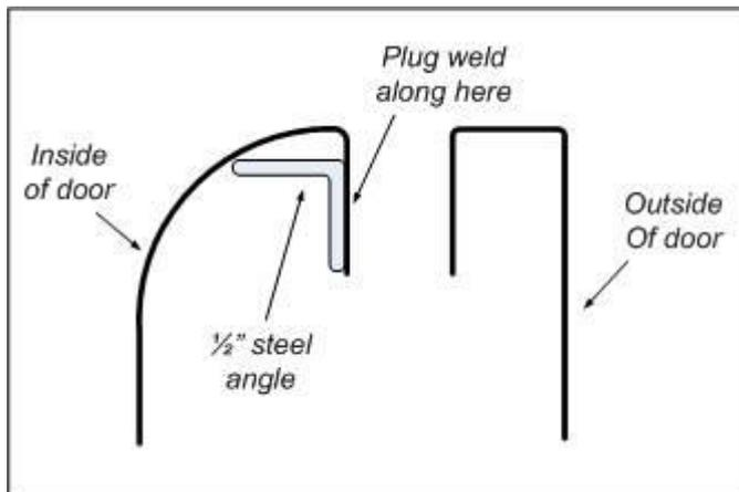
Première étape consiste à couper un morceau de cornière en acier pour s'adapter à l'intérieur de la porte. Avis j'ai ai coupé les encoches dans l'angle pour effacer les fentes pour le coupe-bise de la fenêtre. J'ai également percé de trous à l'intérieur de la porte pour les soudures en bouchon maintenir l'angle en place.
