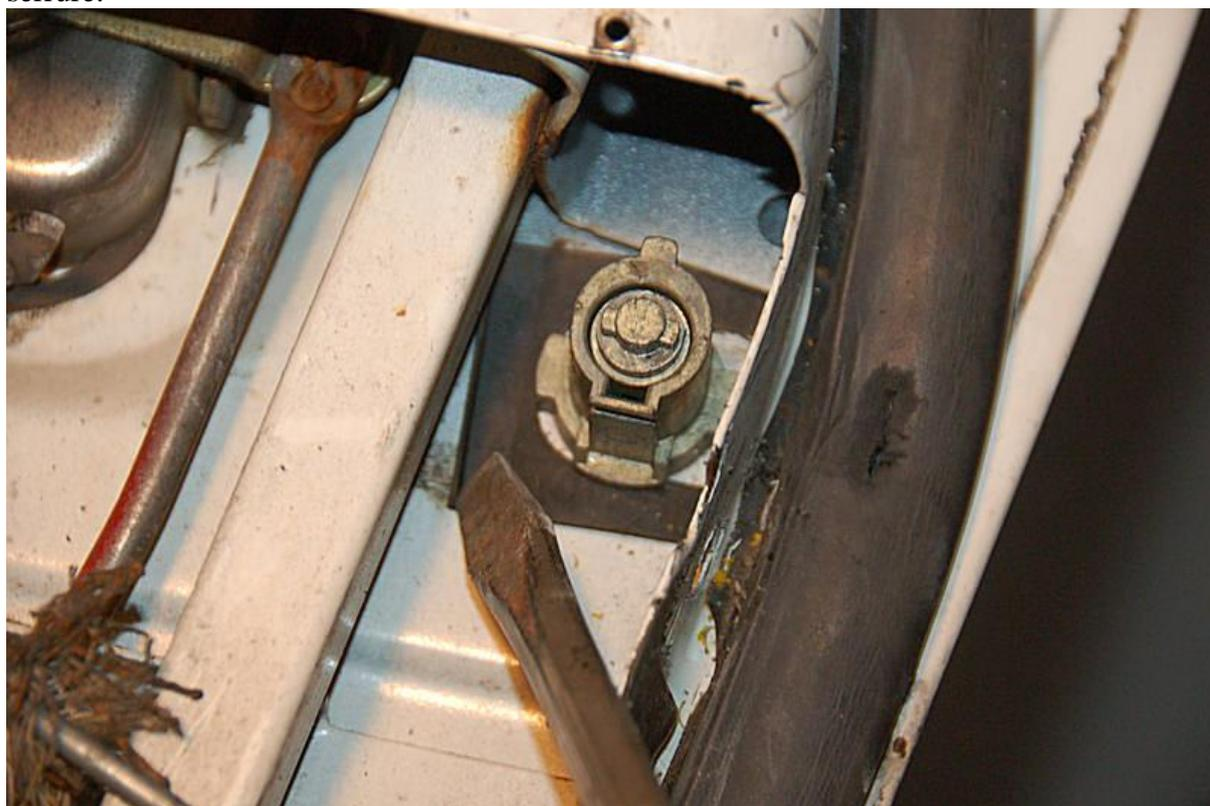
Une fois que le clip est supprimé, poussez le cylindre de la serrure du trou dans la porte. Voici les pièces démontées.
