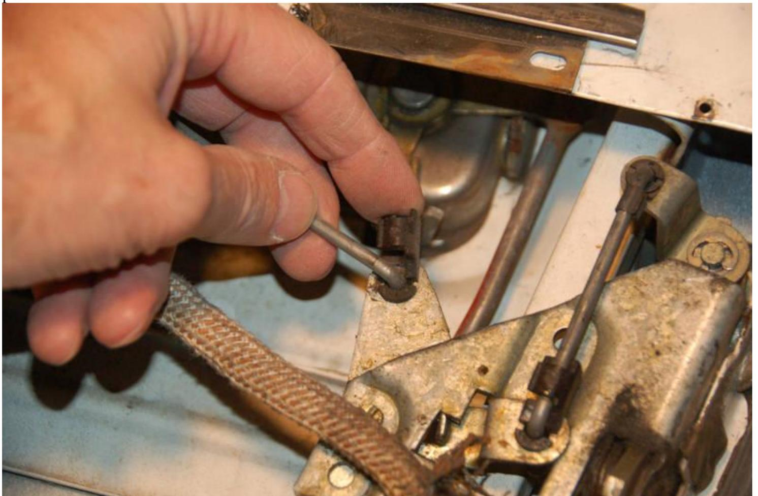
Au fond de la serrure, mécanisme est la tige de libération du verrou de la poignée de porte extérieure (ce point de vue est à la recherche à l'envers vers le bas de la porte). Cette tige va depuis la poignée de porte extérieure, vers le bas de la porte, et puis il boucle retour jusqu'à le mécanisme de verrouillage. Il est maintenu en place par un clip en épingle à cheveux. Je suis enlever la pince avec une pince sur cette photo.
