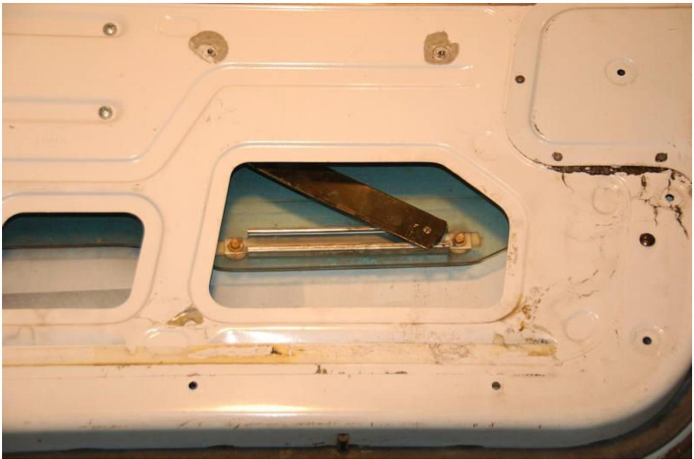
Pour enlever le verre, manivelle la fenêtre tout en bas et en déplaçant la fenêtre un peu vers la gauche (en regardant l'intérieur panneau de la porte passager), vous pouvez glisser la roue sur l'extrémité du bras régulateur du chenal. Une fois que la roue est sorti du chenal, le verre peut être tiré vers le haut à travers l'ouverture indiquée ci-dessous.
