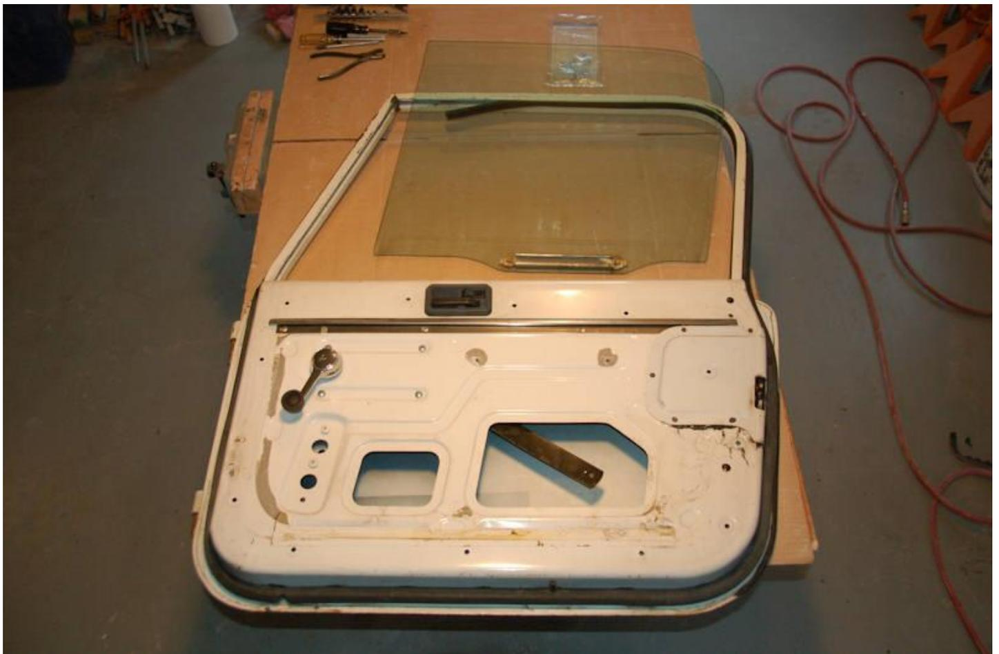
Enfin, supprimer la chaîne de coupe-froid qui va autour de l'arceau de la fenêtre et à l'arrière de la porte. Il devrait sortir facilement.
