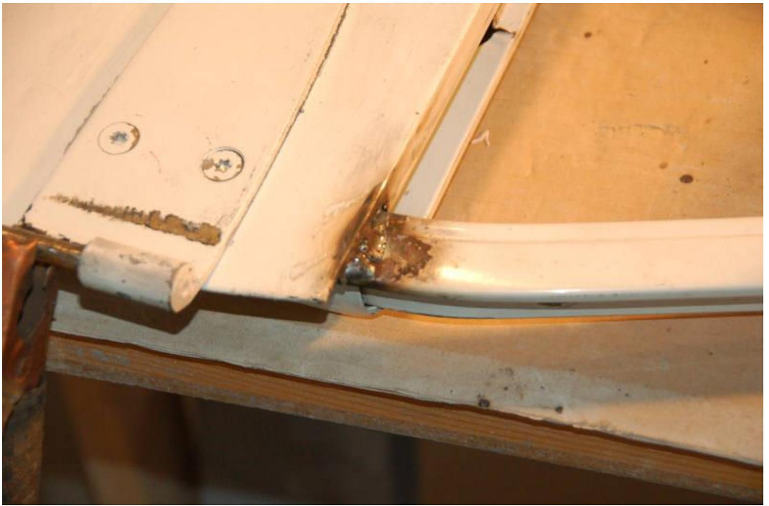
La photo suivante montre un gros plan de l'articulation après la soudure a été meulé lisse pour créer un filet arrondi agréable entre l'arceau de porte et la peau de porte. Quand peint cela ressemblera exactement au filet sur portes TJ et empêchera l'entrée de l'eau et le problème de rouille cerceau.
