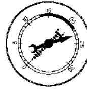
SEGMENTS USES OU HUILE DILUEE EN ACCELERATION/ DECELERATION RAPIDE
