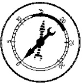
ETRANGLEMENT DE L'ECHAPPEMENT (S'APPROCHE DE ZERO QUAND LA VITESSE DU MOTEUR AUGMENTE)
